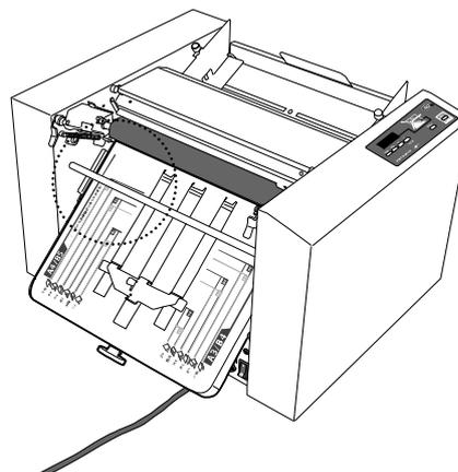
突起部分にカセット2を滑らすように、斜め45度程度の角度でカチとなる所まで差し込みます。
