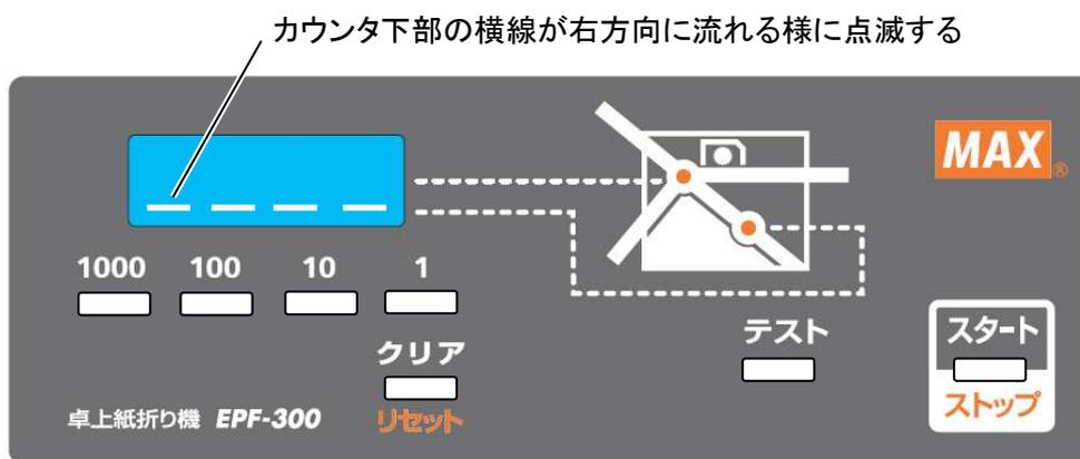
排紙センサー(受光、発光)部に用紙の破片及び紙粉などが付着すると上記エラーが発生します。このような場合は、綿棒など柔らかいもので付着した紙粉や用紙の破片などを取り除いてください。
