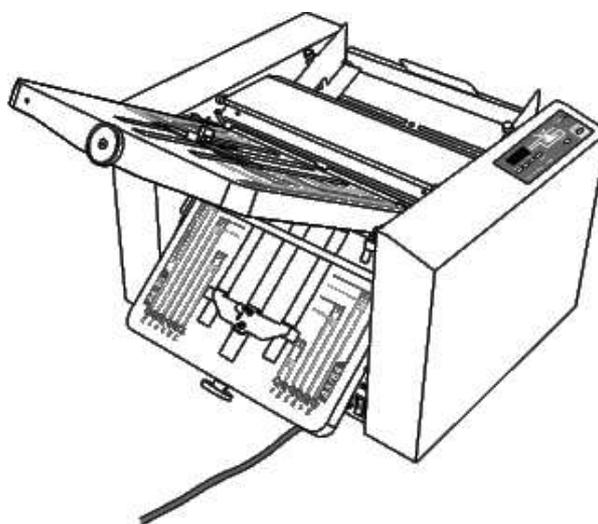
両側にある丸印の折りカセット1ガイドに沿わせるようにして、折りカセット1をカチとなる所まで差し込みます。
