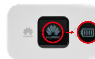
電源が OFF の状態で充電をすると、画面にロゴマークが表示され、次に充電中マークが表示されます。
