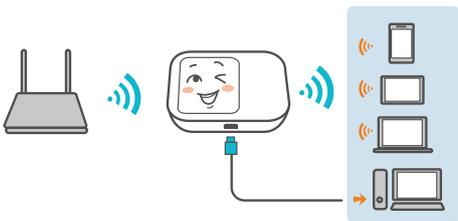
Wi-Fi中継機能により、Wi-Fiのカバーエリアが広がり、利用可能なWi-Fiネットワークに接続できるため、モバイルデータの通信量を削減できます。
