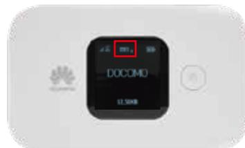
Wi-Fi に接続すると Wi-Fi アイコン (インターネット接続中アイコン) が点灯します。
