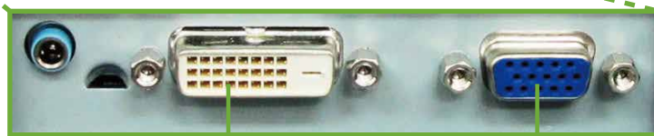
DVI-D アナログ RGB ミニ D-SUB(15ピン)
